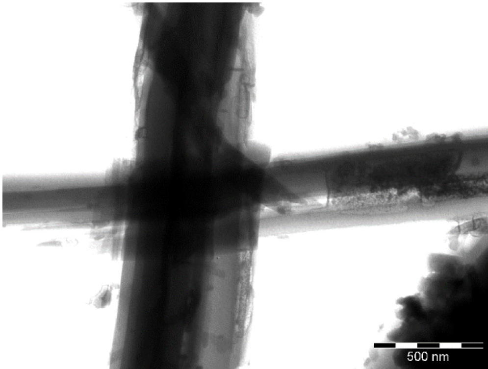
Figure 3. Micrographie électronique pour Per_2 [Au(mnt)_2] en l'absence d'agent de contrôle de la croissance (barre = 500 nm).
