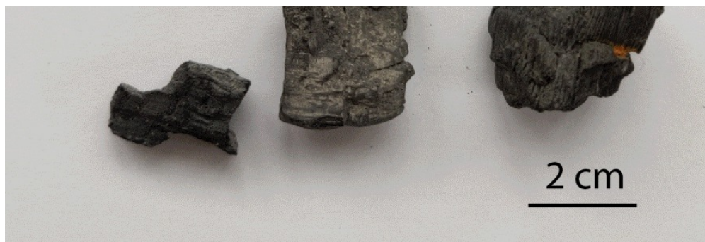
Figure 3. (a) Poutres carbonisées sous l'ouverture de la nef (photo de Damien Deldicque et Jean-Noël Rouzaud). (b) Charbons échantillonnés.
