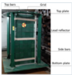
Fig. 1 Assemblage combustible Th-Pb dans le bunker d'irradiation.
